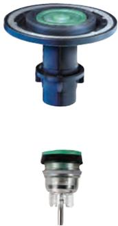
冲洗阀采用两种不同的技术制造 — 采用柔性橡胶片的是隔膜式，采用模制塑料杯的是活塞式。每种冲洗阀的运作原理基本相同，但不同影响因素的组合，例如卫生间客流量、水质和操作系统，可能会使某种技术类型在特定环境下优于其他类型。使用下列清单为您未来的商用卫生间项目选择最佳的阀门技术。
