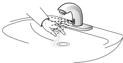
1. Placez les mains sous le robinet. La valve solénoïde doit produire un clic, le voyant DEL dans la fenêtre du détecteur doit clignoter une fois et l'eau doit s'écouler du bec d'écoulement.
