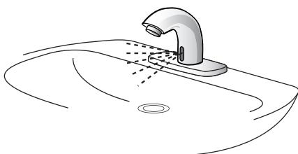
2. Lorsque vous éloignez les mains, l'écoulement d'eau doit s'arrêter.
